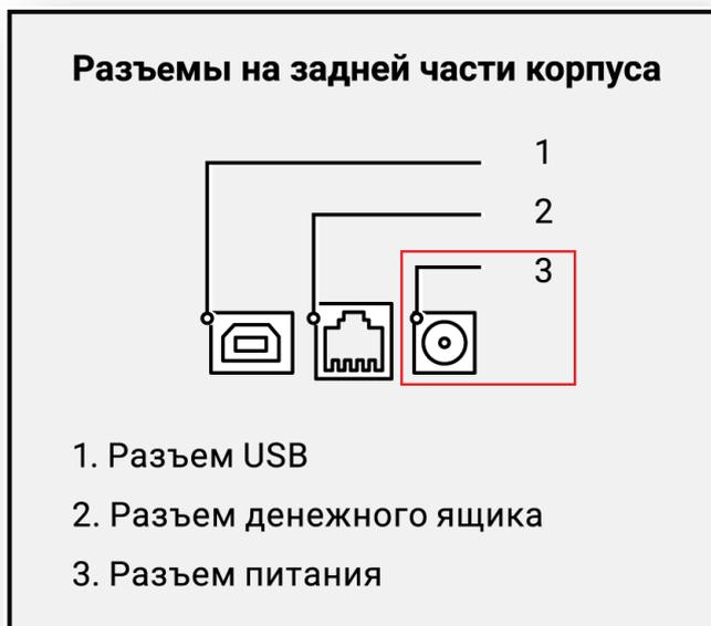
3. Вставьте один конец соединительного USB-кабеля в USB-разъем вашего ПК, в другой в разъем (1) ККТ.
